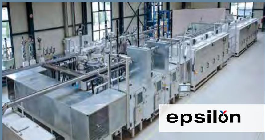
In Umlaufgießanlagen sind sämtliche Prozessschritte vom Formhandling bis zum Aushärten integriert und automatisiert. Diese Anlagen kommen zumeist in der Großserienfertigung zum Einsatz.
