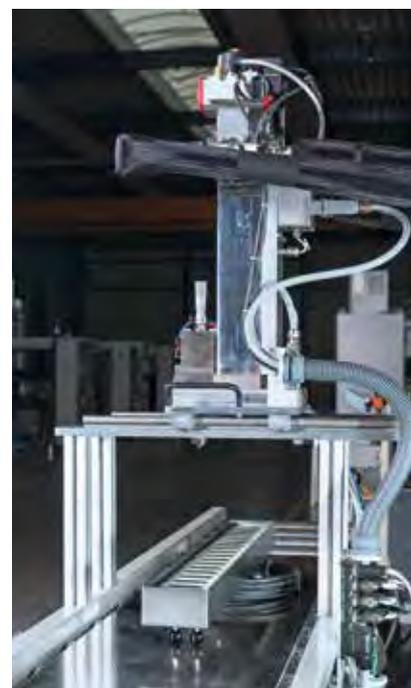
Die Menge des zu dosierenden und zu vergießenden Materials je Bauteil variiert zwischen wenigen Milligramm, z.B. bei Bauteilen für die Mikro-Elektronik, und mehreren Hundert Kilogramm, z. B. bei MRT-Spulen. Zudem variieren die zu produzierenden Stückzahlen und damit die vorzuhaltenden Kapazitäten. Dieser Bandbreite tragen wir mit unseren unterschiedlichen Misch- und Dosieranlagen der Typreihen micro, compact und epsilon Rechnung.
